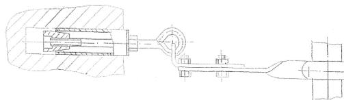
Схема крепления лесов к стене
